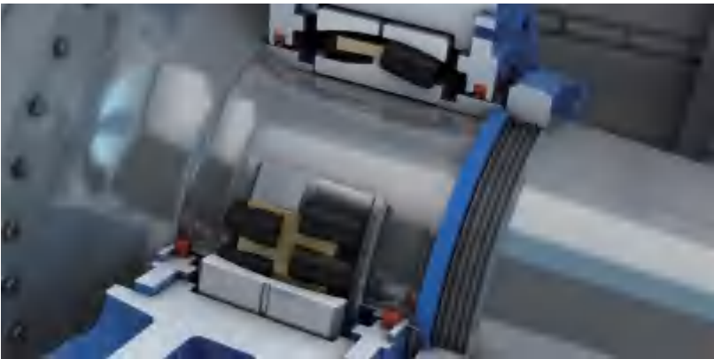
旋转轴密封的基本功能：保持润滑油在系统内，防止污染物进入系统，保护被润滑的轴承
